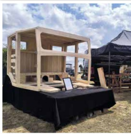
Nachbau einer hölzernen Fahrerkabine für einen Hanomag SS100
